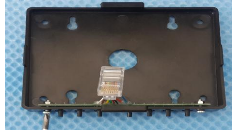
Şekil 15: Tuş takımı PCB si yerleştirilir ve vidalanır.
