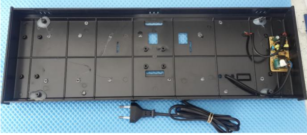
Şekil 10 : Panelin alt kapağı.(güç bağlantısı yapılmış)
