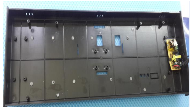
Şekil 7 : Arka kapağa sıcak silikon yapıştırılır.
